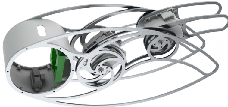
Abbildung 6.1: Zweidimensionaler Roboter: Der Roboter verfügt über zwei Servomotoren an einem „Bein“. Im Kopf ist ein Abstandssensor und ein AccelBoard3D verbaut.
